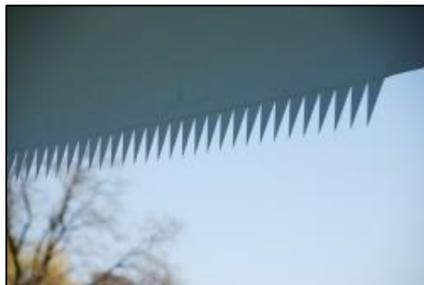
Figure IV.5-3 : Serrated trailing edge ou peignes acoustiques (source Engie Electrabel)
