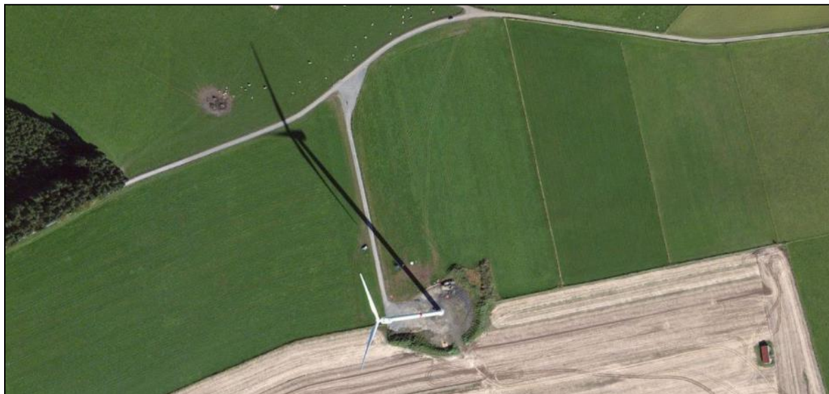
Figure IV.4-7 : Ombre portée d'une éolienne. L'observateur placé dans l'ombre du rotor subit un effet stroboscopique.
